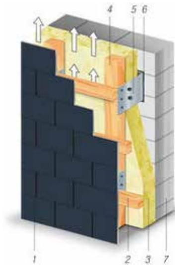
Gleich, welches Format oder Material: Vorgehängte hinterlüftete Fassaden (VHF) erreichen nach heutigem Stand der Technik die höchste Funktionssicherheit und Dauerhaftigkeit. Sie sind wartungsarm und bieten ein schier unerschöpfliches Gestaltungspotenzial.
